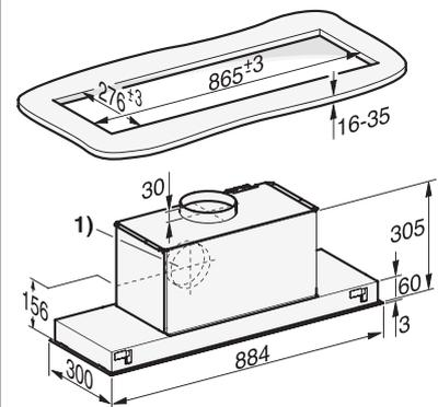
Die Dunstabzugshaube wird mit Hilfe von Klemmen im Ausschnitt befestigt. Hierfür ist eine massive Ausführung der Einbaufäche, z. B. aus Holz, erforderlich. Achten Sie auf eine ausreichende Tragfähigkeit der Konstruktion. Im Bereich der Klemmen müssen Bauteile, wie Streben oder Leitungen, einen Abstand von mindestens 25 mm vom Ausschnitt haben.
