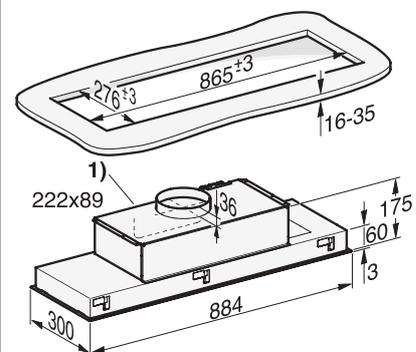
Die Dunstabzugshaube wird mit Hilfe von Klemmen im Ausschnitt befestigt. Hierfür ist eine massive Ausführung der Einbaufäche, z. B. aus Holz, erforderlich. Achten Sie auf eine ausreichende Tragfähigkeit der Konstruktion. Im Bereich der Klemmen müssen Bauteile, wie Streben oder Leitungen, einen Abstand von mindestens 25 mm vom Ausschnitt haben.
